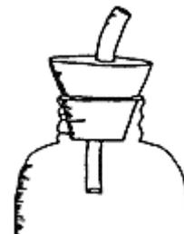
C. Reliez un ballon au tuyau et attachez-le avec un élastique. Avec du scotch, de la pâte à modeler ou de la cire, rendez l'ensemble hermétique au niveau du bouchon.
